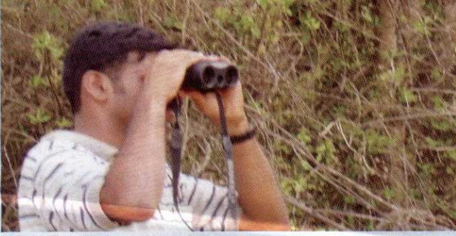
ಬೈನಾಕ್ಯುಲರ್ ಅಲ್ಲ! ರೇಂಜ್ ಫೈಂಡರ್ ಎಂಬ ಉಪಕರಣ. ಇದರಿಂದ ನಾವು ನಿಂತಿರುವ ಸ್ಥಳಕ್ಕೂ ಪ್ರಾಣಿಗೂ ಇರುವ ದೂರವನ್ನು ಕಂಡುಕೊಳ್ಳಬಹುದು. ಚಿತ್ರ: ಕೆ.ಎಸ್. ನವೀನ್
